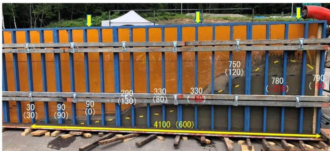
写真 6-15 10秒締固め
