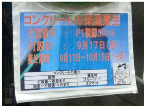
脱型までブルーシートで1週間、脱型後ミラマットで3週間
