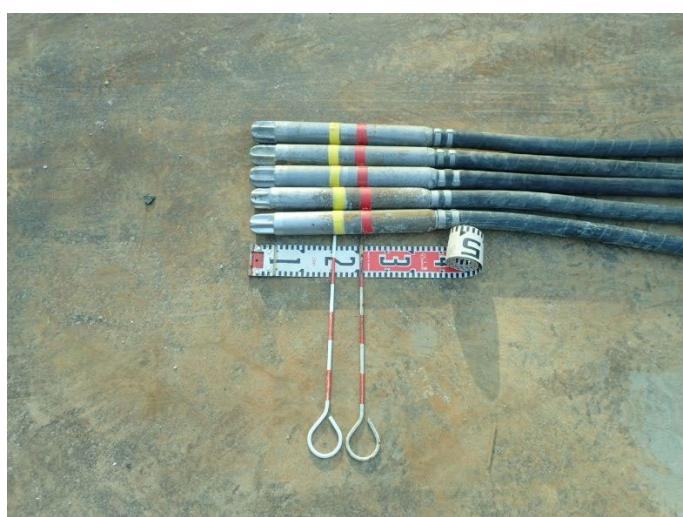
写真 7-⑱ バイブルレタ挿入目印のマーキング例
