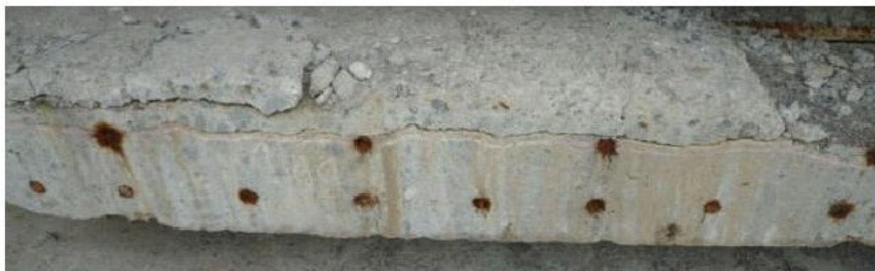
写真 1-⑰ 床版交換により撤去したRC床版（S 55年竣工）の上縁鉄筋に沿ったひび割れとその上部コンクリートの劣化状況
