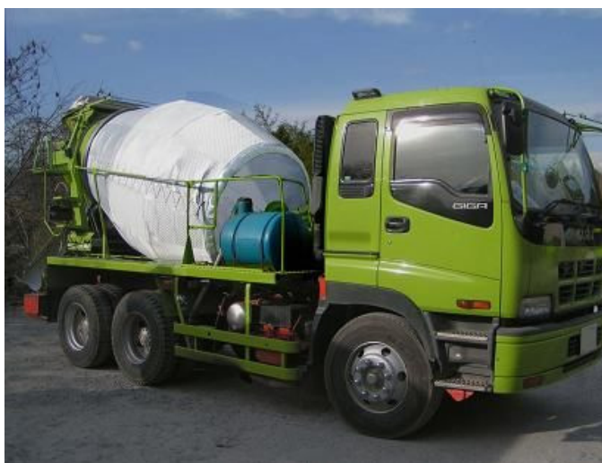
写-解 4.1 アジテータ車のドラムカバー装着例[NETIS:CG-110012-A]
