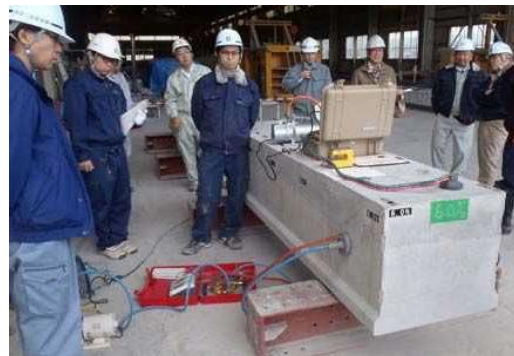
写真-2 表層透気性に関する調査状況
