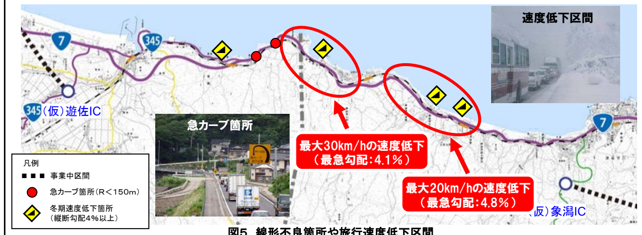
図5 線形不良箇所や旅行速度低下区間
