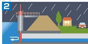
2 洪水により川の水位が高くなると、川の水が樋門を通して住宅側に流れ込み（逆流）、浸水被害が発生するため、樋門の扉を閉めます。
