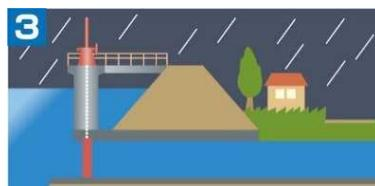
3 樋門の扉を閉めると、住宅側の水の行き場がなくなり、住宅地が浸水する（内水被害）場合があります。そのため、内水被害が発生する場所には排水機場を設置したり、排水ポンプ車で排水するなどの対策を講じています。
