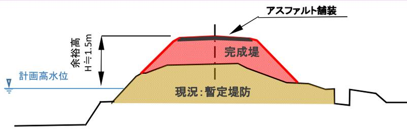
米代川の堤防は、100年に1度発生する規模の洪水時の水位（計画高水位）を計算し、余裕高1.5mを加えた高さで完成堤となります。
