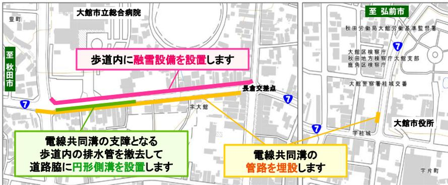
※電線共同溝の支障となる水道管の移設工事（大館市）も行われています。
