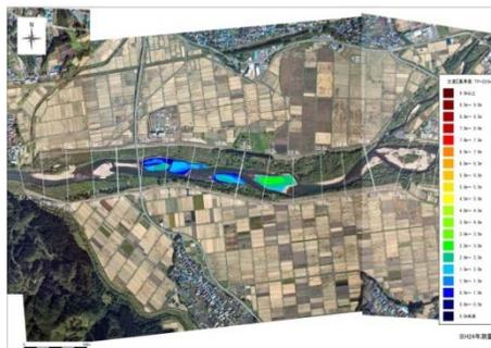
3次元計測による河道状況の評価
