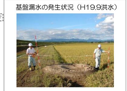
基盤漏水の発生状況（H19.9洪水）
