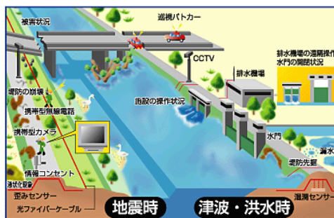
図 6-36 河川管理施設の高度化イメージ
