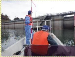
盛岡工業高等学校の土木科3年生のみなさんが、総合的な探究活動の一環として四十四田ダムをフィールドとして貯水池の測量を行いました。堤体の上の天端に測量器械を設置して湖面を移動する船の位置等を計測していました。
