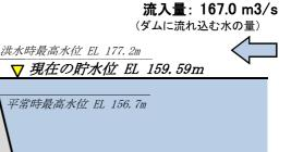
ダム地点雨量: 62.0 mm (13時時点) 貯水位(EL): 159.59 m ダム流入量: 167.0 m3/s
