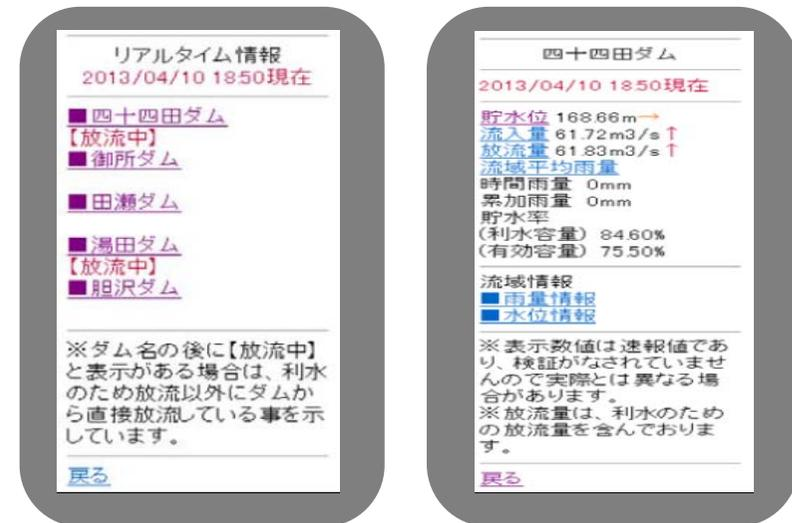
四十四田・御所・田瀬・湯田・胆沢ダムの「貯水位」、「流入量」、「放流量」、「下流水位の低減効果」等の情報が確認できます。
