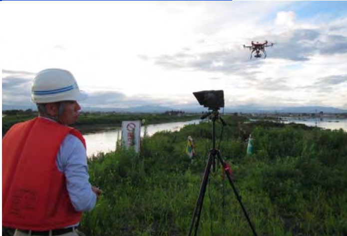
UAV等を活用し、被災状況の調査を実施
