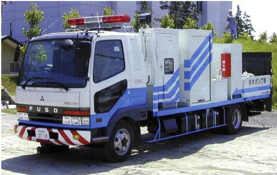
排水ポンプ車(排水能力毎分 $30\text{m}^3$ の水中モータ式)
