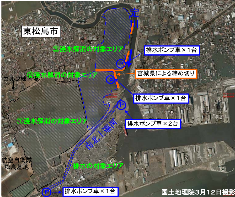
東松島市大曲地区、浸水解消の対象エリア 現在、排水ポンプ車合計 5台で排水中。 ※排水ポンプ車の配置は、現地の状況に応じて多少移動しています。
