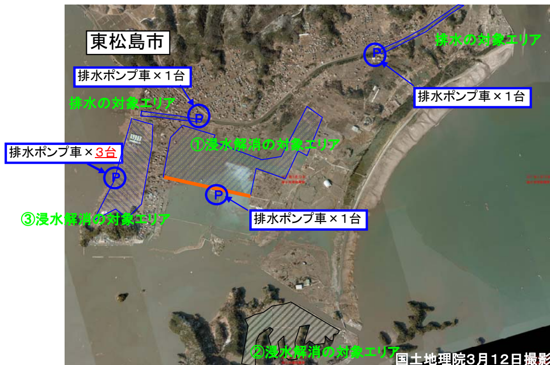
東松島市東名地区、浸水解消の対象エリア 現在、排水ポンプ車合計 6台で排水中。
