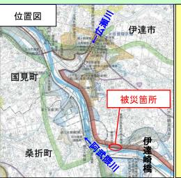
3月11日発生の震度6弱の地震により、阿武隈川上流右岸11.0k+110m~11.4k (L=290m)の東根川地区堤防が堤防断面内にゆるみ部分が生じたため法崩れを起こし、堤防天端の陥没等の被災を受けました。
