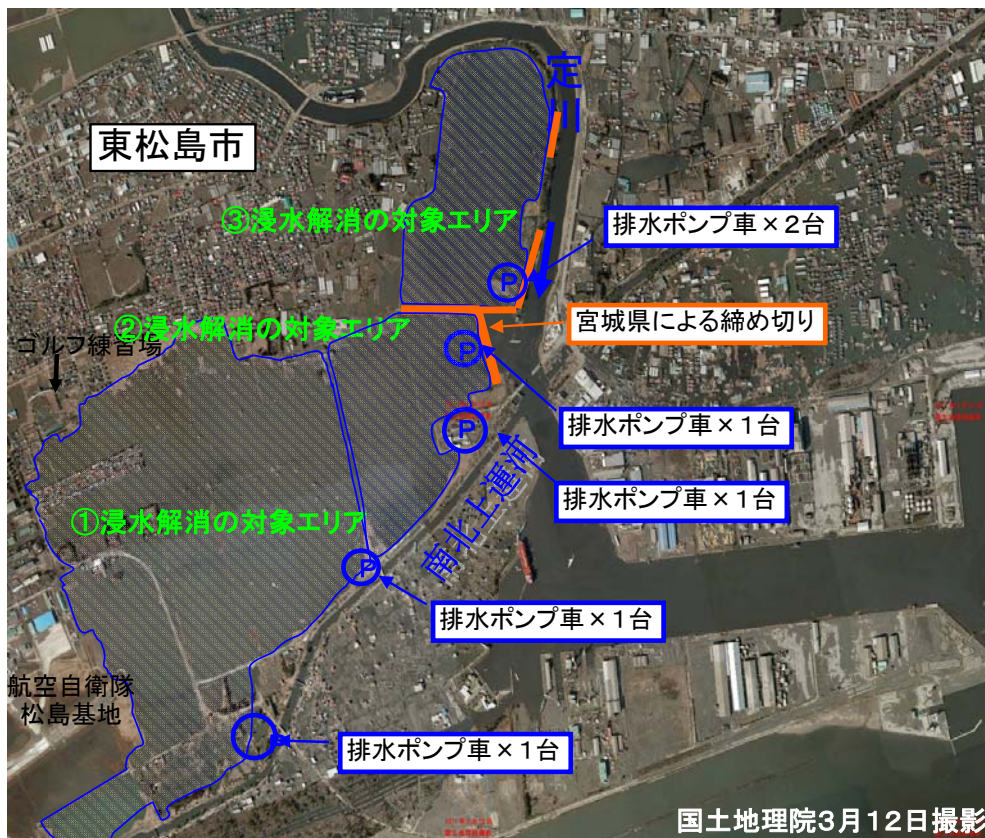
東松島市大曲地区、浸水解消の対象エリア 現在、排水ポンプ車合計 6台 で排水中。
