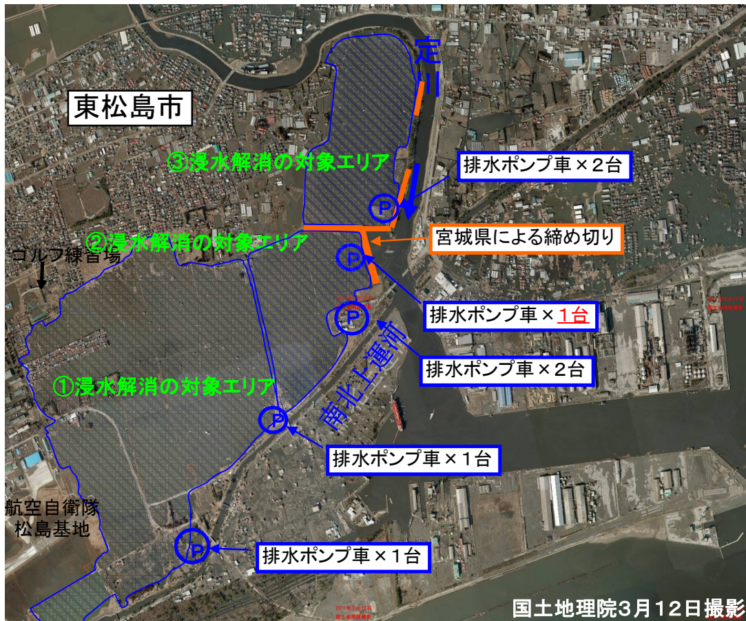
東松島市大曲地区、浸水解消の対象エリア 現在、排水ポンプ車合計 7台 で排水中。
