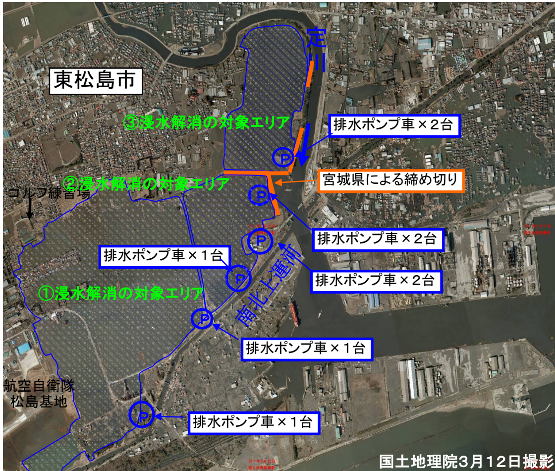
東松島市大曲地区、浸水解消の対象エリア 現在、排水ポンプ車合計 9台で排水中。
