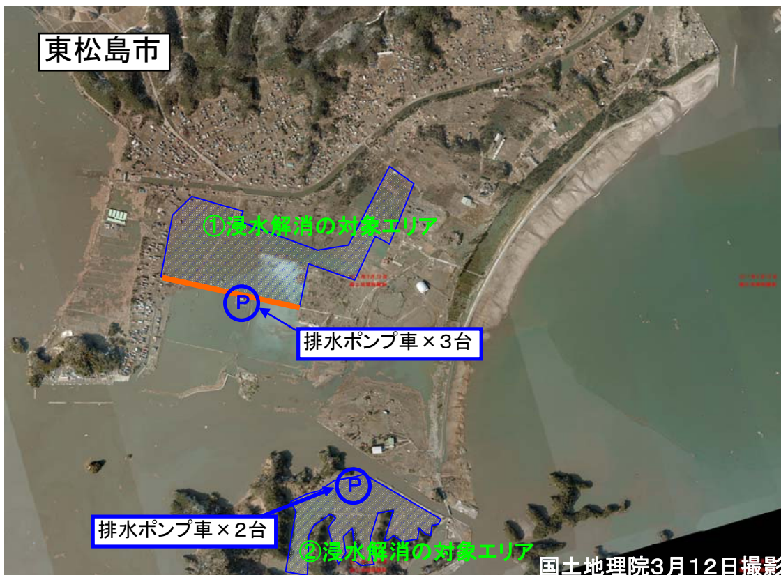
東松島市東名地区、浸水解消の対象エリア 現在、排水ポンプ車合計 5台で排水中。
