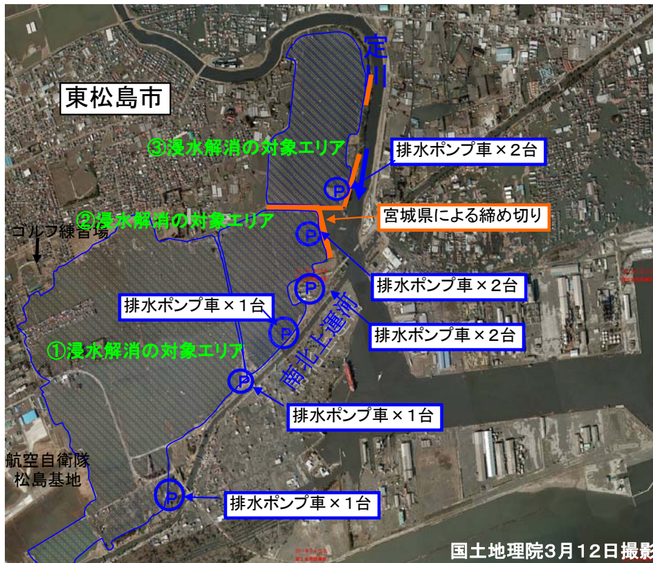
東松島市大曲地区、浸水解消エリア 現在、排水ポンプ車合計 9台で排水中。 ※排水ポンプ車の配置は、現地の状況に応じて多少移動しています。
