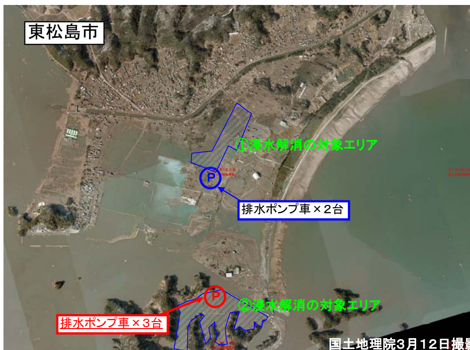
東松島市東名地区、浸水解消エリア 現在、排水ポンプ車合計 5台 で排水中。
