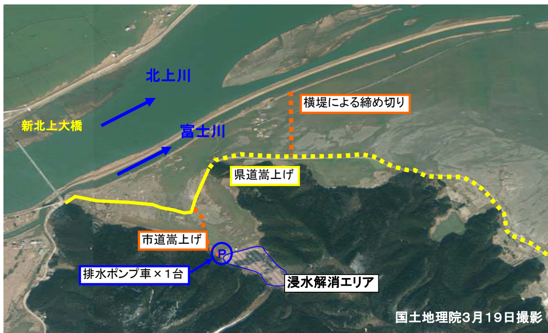
石巻市釜谷地区(東側) 12日から排水ポンプ車で排水実施。
