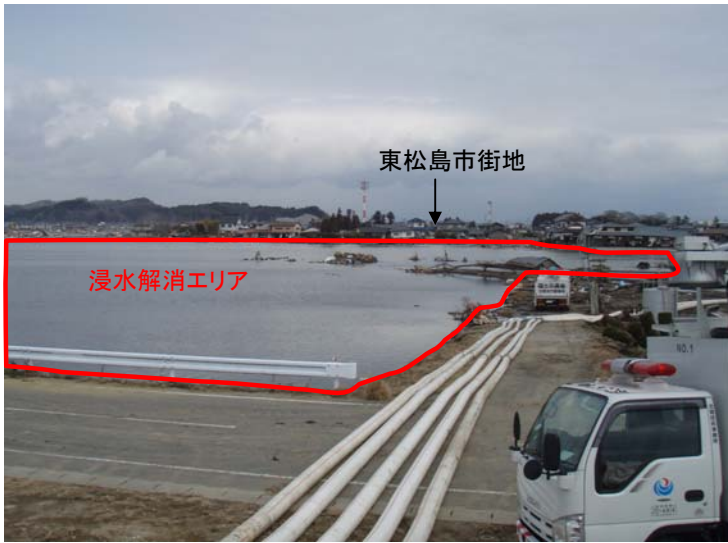
東松島市大曲地区、浸水解消エリア 現在、排水ポンプ車合計 12台で排水中。 ※排水ポンプ車の配置は、現地の状況に応じて多少移動しています。
