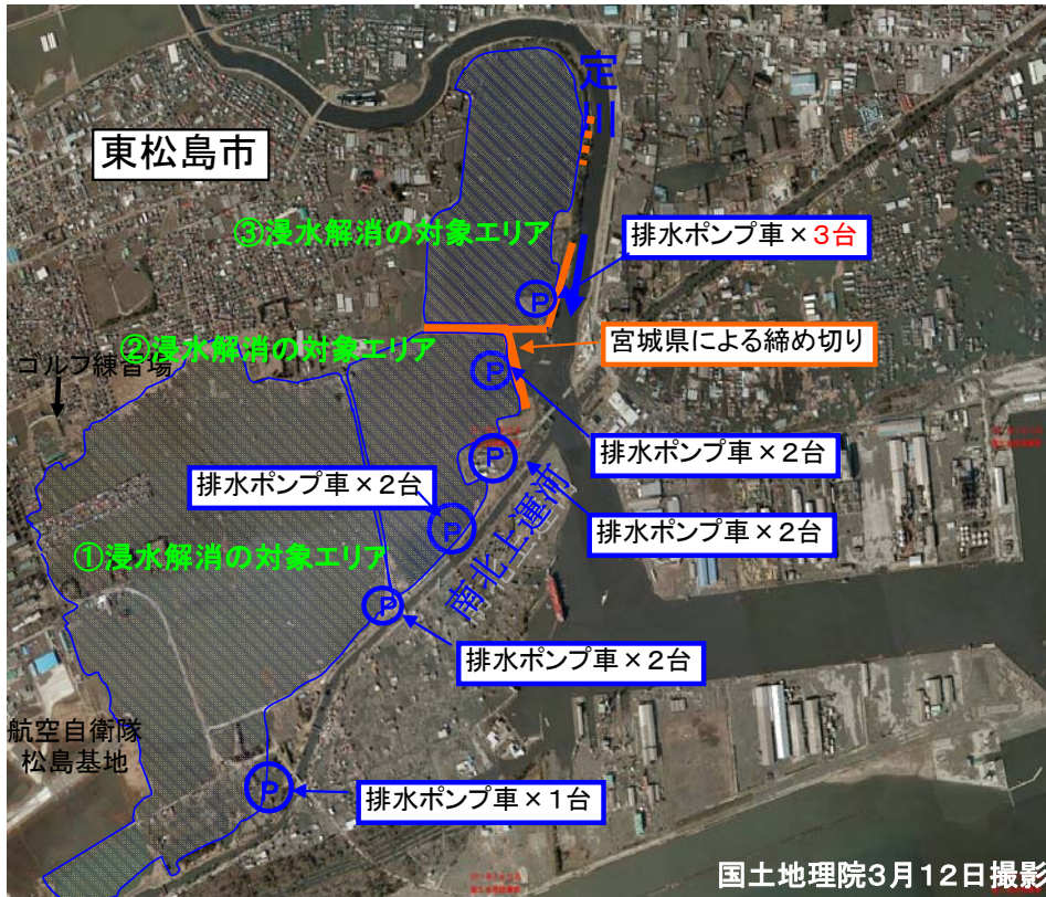
東松島市大曲地区、浸水解消エリア 現在、排水ポンプ車合計 12台で排水中。 ※排水ポンプ車の配置は、現地の状況に応じて多少移動しています。
