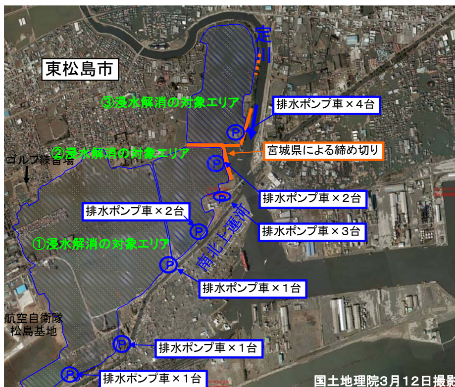
東松島市大曲地区、浸水解消エリア 現在、排水ポンプ車合計 14台で排水中。 ※排水ポンプ車の配置は、現地の状況に応じて多少移動しています。
