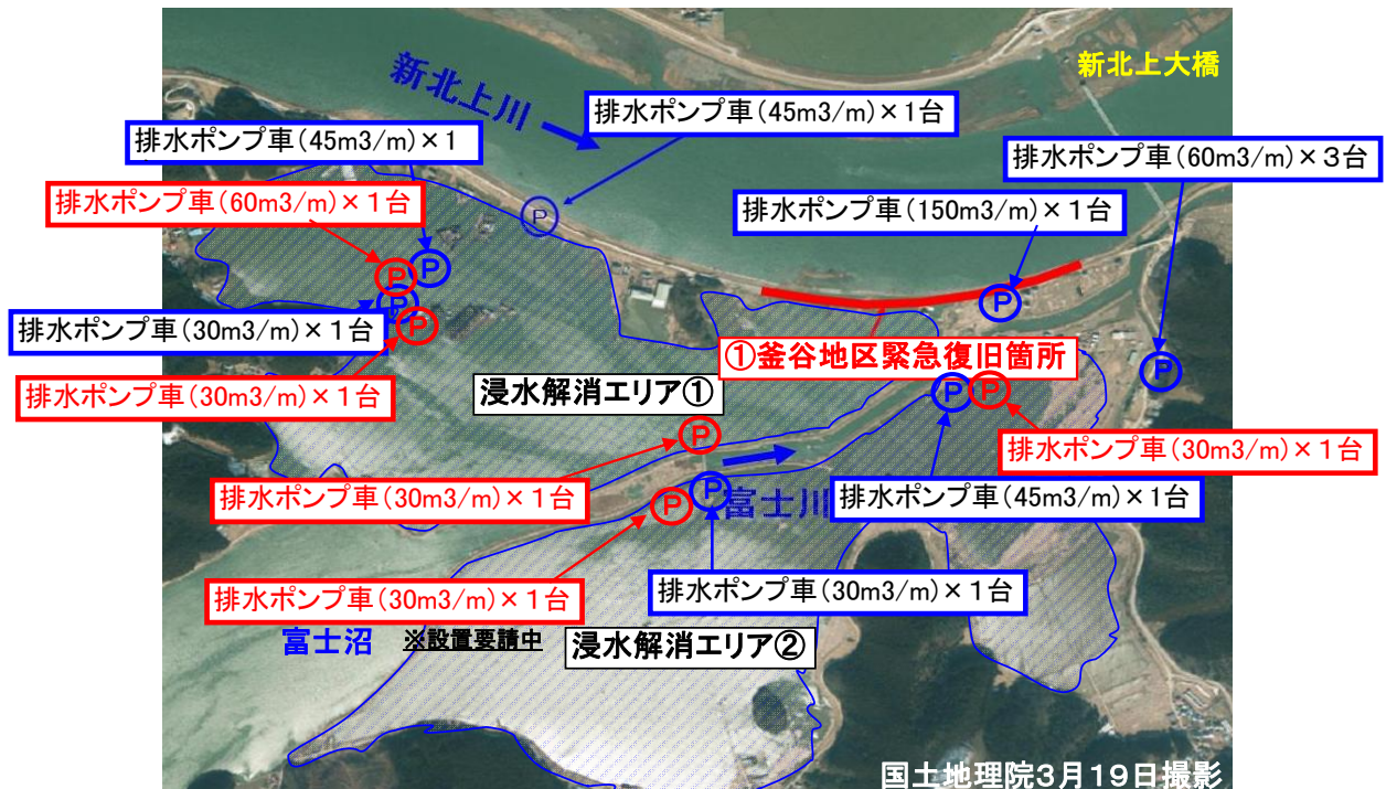
石巻市釜谷地区 浸水解消エリア 4月6日排水ポンプ車増強5台
