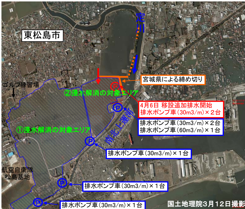
東松島市大曲地区、浸水解消エリア 4月6日排水ポンプ車増強 2台
