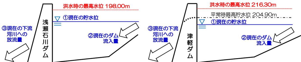
※津軽ダムは平常時最高貯水位を超えるとダムからの越流が開始する自然調節方式のダムです。
