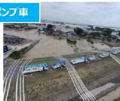
大雨、洪水、津波などにより生じた滞留水を早期に解消するため、排水ポンプ車で排水することができます。
