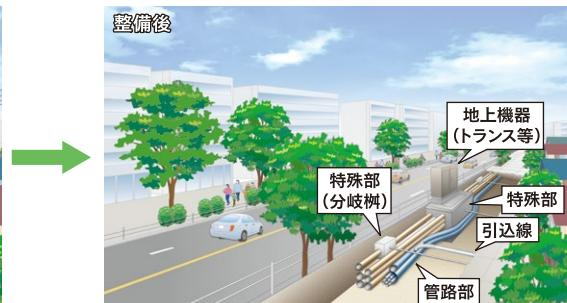
管 路 部：電力や通信用のケーブルを収容する管路
