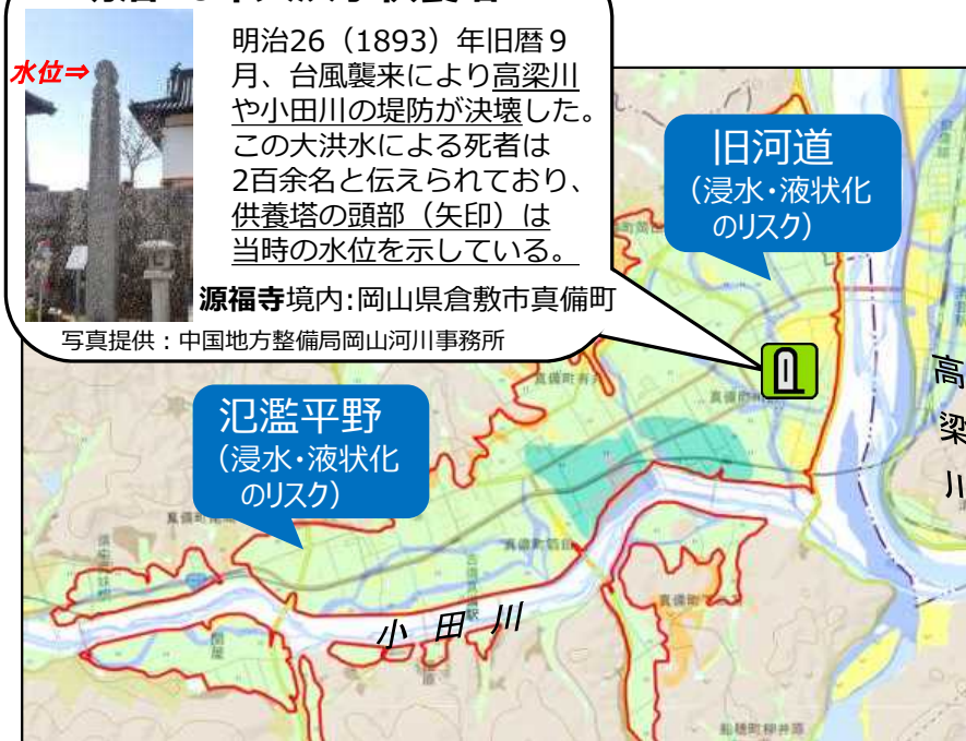
地形特性情報と災害履歴情報を「地理院地図」上で重ね合わせ
