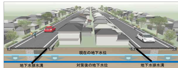
道路と宅地との一体的な液状化対策を行う工法のイメージ（地下水水位低下工法）
