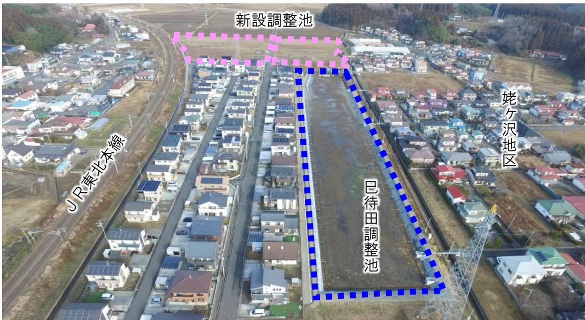
下水道事業等により、「雨水を貯留する施設」の整備を進め、河川への流出を抑制
