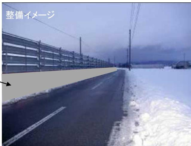
防雪柵の下部構造に止水機能を持たせる
