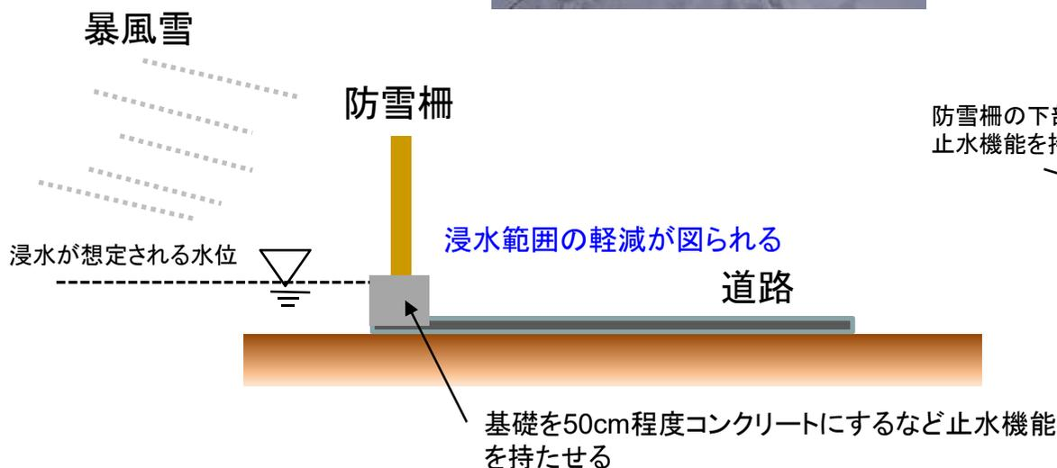
防雪柵の下部構造に止水機能を持たせる
