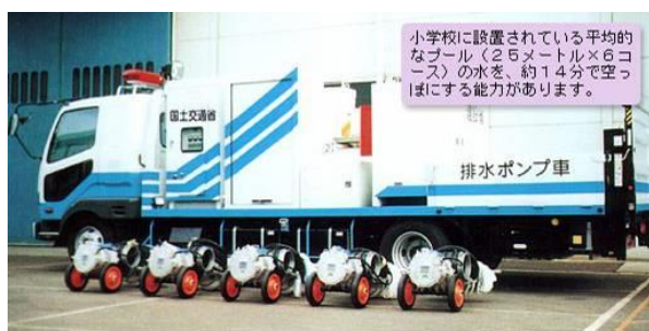
(水中ポンプ能力=30m 3 /分)
