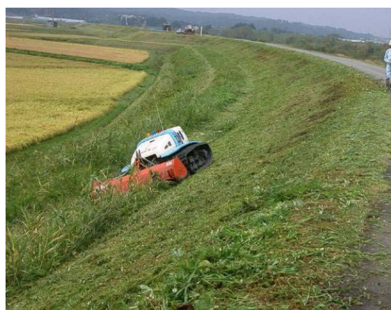
堤防法面の除草
